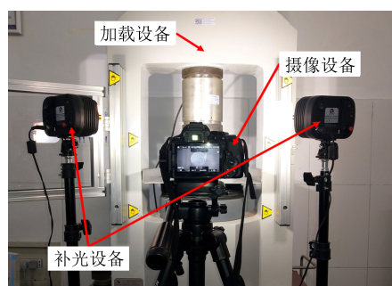
图 2 巴西劈裂试验系统 Fig.2 Brazilian test system
